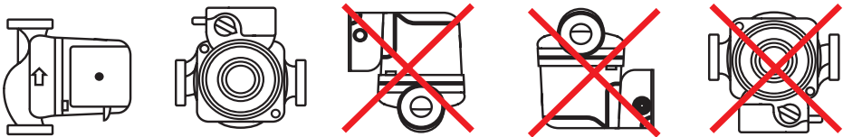
Рис.2. Положение электронасосов при монтаже
