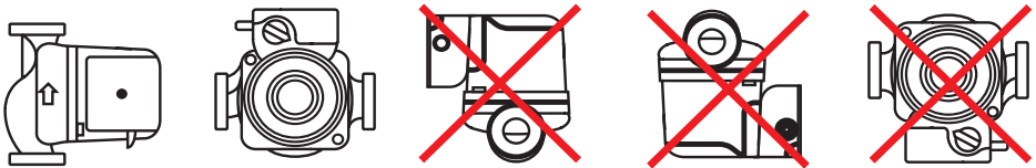
Мал. 2. Положення електронасосів під час монтажу
